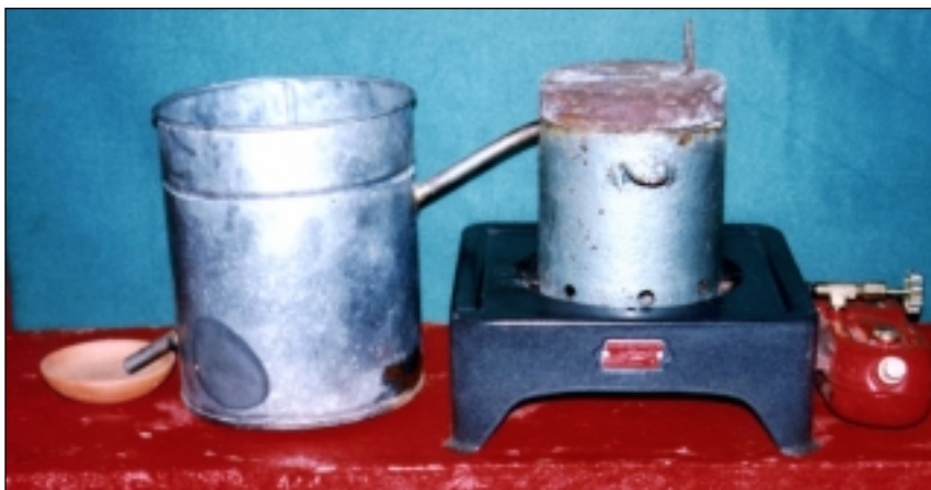
Figura 6. Sistema de destilación a gasolina
