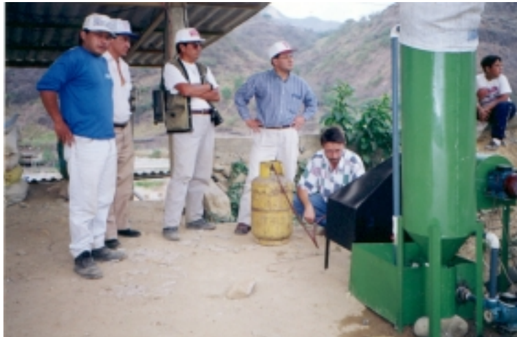
Horno para la quema de amalgama, desarrollado por Técnicos del Proyecto-COSUDE
