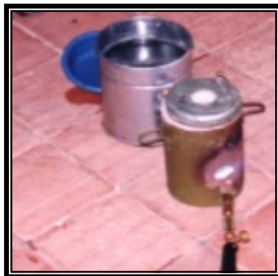
Figura 12. Modelo propio de sistema de tratamiento de amalgamas. En primer lugar el quemador, luego la hornilla, después la retorta y por último el receptor del mercurio destilado.
