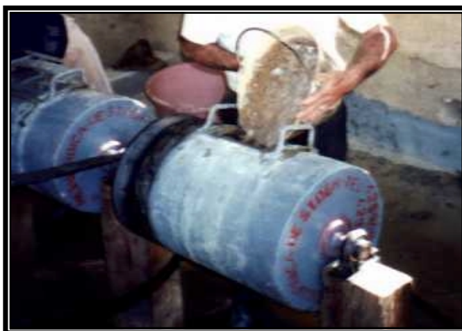
Figura 11. Tipo de barril o tambor amalgamador utilizado en la región.
