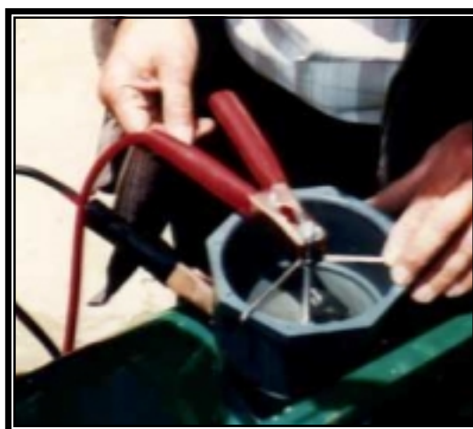
Figura 14. Activador de mercurio conectado a una batería de 12 voltios para limpiar la superficie del mercurio recuperado en las etapas anteriores.
