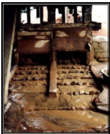
Figura 10a. Sistema antiguo de Concentración gravimétrica (canaletas).
